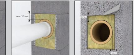
35. Нанесите растер, используя монтажный шаблон, который идет в комплекте поставки. Контролируйте положение блока с помощью строительного уровня. Не сдвигайте дымоход с конструктивных зазоров, соблюдайте зазоры согласно п.36.
