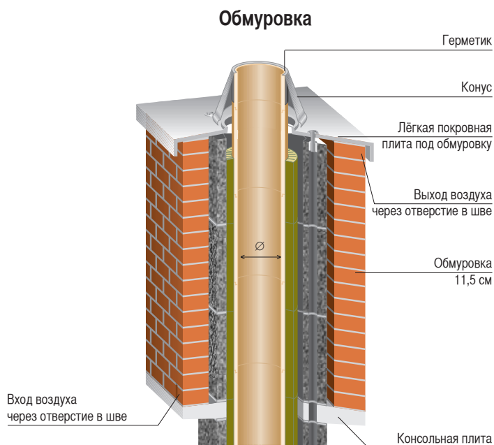
Выполняемая по месту обмуровка на консольной плите
